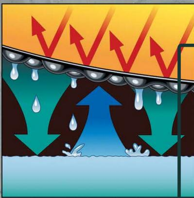
Das Material von VapourGuard<sup>TM</sup> sorgt für Verdunstungskontrolle, Algen- und Ablagerungshemmung und Temperaturregulierung. Das Material kann in modularen Abschnitten oder als komplette Abdeckmembran auf die Wasseroberfläche gelegt werden. Durch kleine Löcher, die während des Herstellungsprozesses hinzugefügt werden, kann die Abdeckung auch für Regenwassergewinnung verwendet werden
